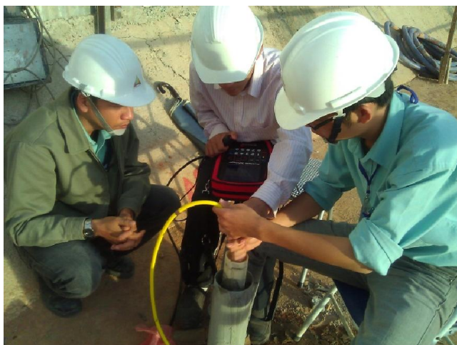
Quan trắc chuyển vị ngang bằng Inclinometer
